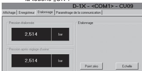
Avec le bouton de commande «Charge Réglage usine», le point zéro peut être remis sur sa valeur initiale tel que réglée à l'usine.
