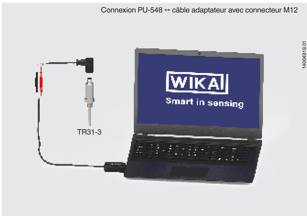
Connexion PU-548 ↔ pinces crocodiles
