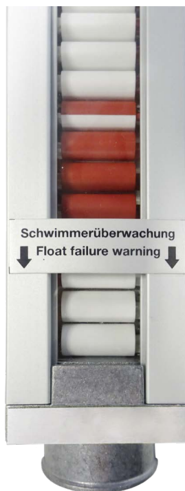
Schwimmer schwimmt (Behälter leer)
