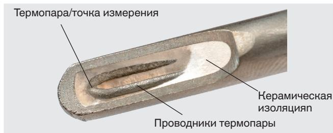
Когда точка измерения нагревается, на концах выводов (холодный спай) измеряется напряжение; оно отображает температуру в точке измерения. (Термоэлектрический эффект также называется эффектом Зеебека.)
