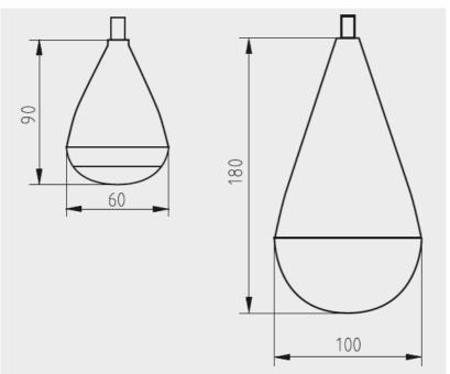
Figura 2: Dimensões da SLS (f.l.t.r. SLS-M2, SLS-MS1)
