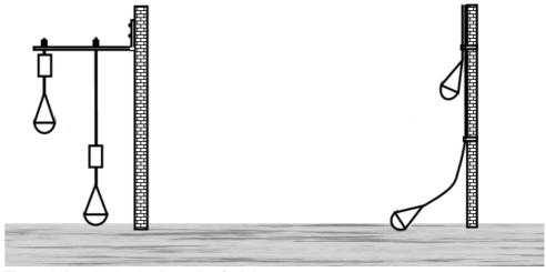
Figura 1: Instalação da chave de nível tipo pera
