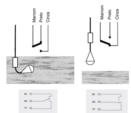
Os fios são conectados dependendo da função, por meio do seguinte diagrama de conexão:
