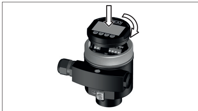
Рис. 38: Установка модуля индикации и настройки в отсеке электроники однокамерного корпуса
