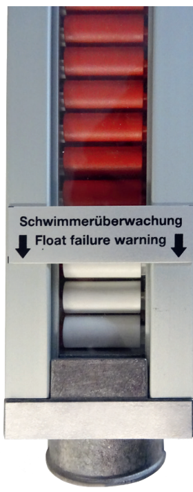
Le flotteur est en train de flotter (récipient rempli)
