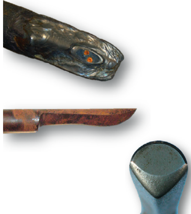
Danni a pozzetti termometrici sollecitati da abrasione (esempi)
