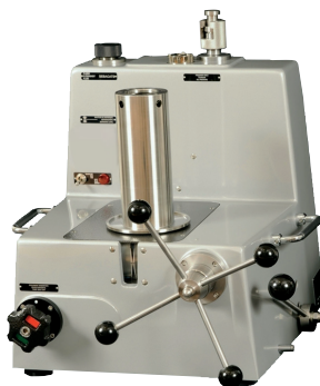
Первичный эталон, грузопоршневой манометр серии CPB6000
