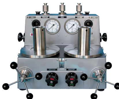
Первичный эталон, дифференциальный грузопоршневой манометр, модель CPB6000DP
